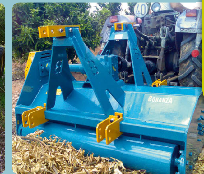
Trituradora universal dos salidas fija, sentido de la marcha hacia delante y hacia detrás.
