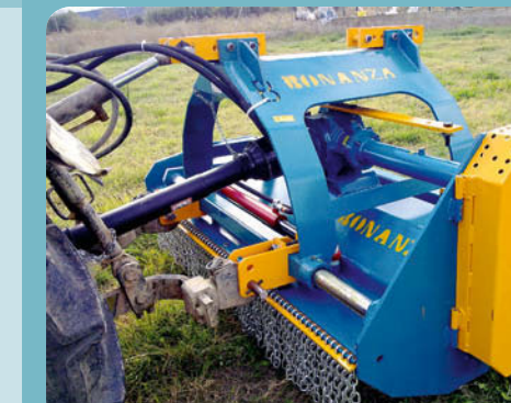
Trituradora universal dos salidas hidráulica, sentido de la marcha hacia delante y hacia detrás.
